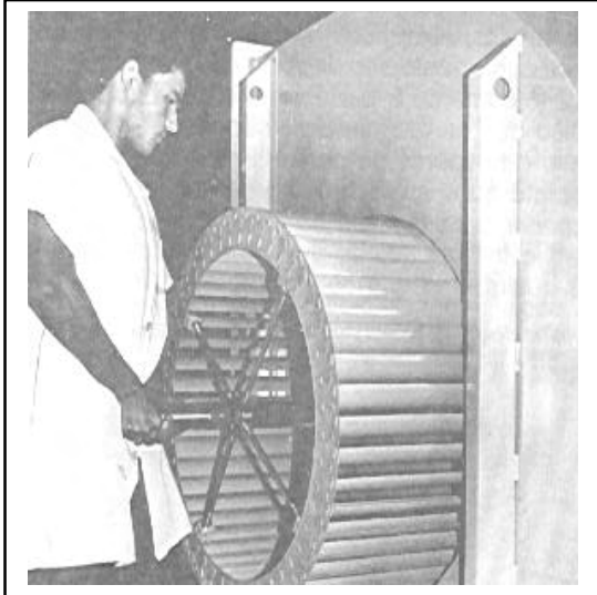
Montagem de rotor na carcaça.
